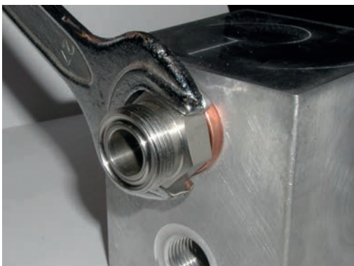
11. Zur Abdichtung des Einschraubzapfens gegenüber Gehäuse oder Block empfehlen wir den Einsatz von Weichmetalldichtungen nach DIN 7603.
