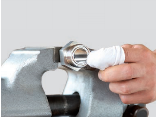
7. DILO-Nut und -Feder vor Zusammenbau reinigen.
