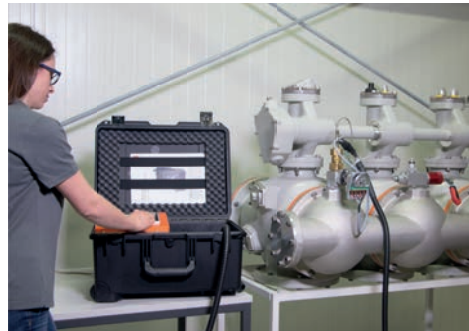
En combinación con una válvula de cierre especial, el aparato para la verificación de densímetros DensiControl IN permite un control fiable de los densímetros en un compartimento de gas.
