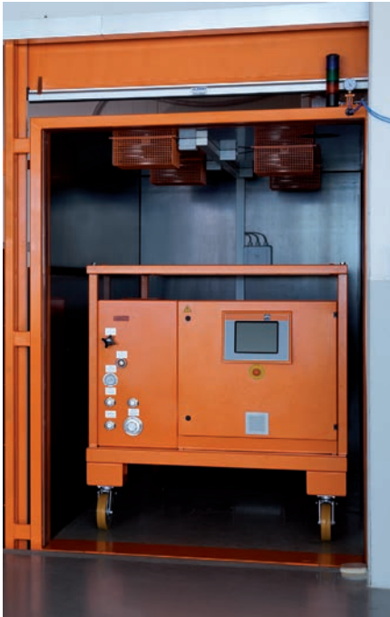
Ejemplo Cámara atmosférica de pruebas con puerta enrollable automática
