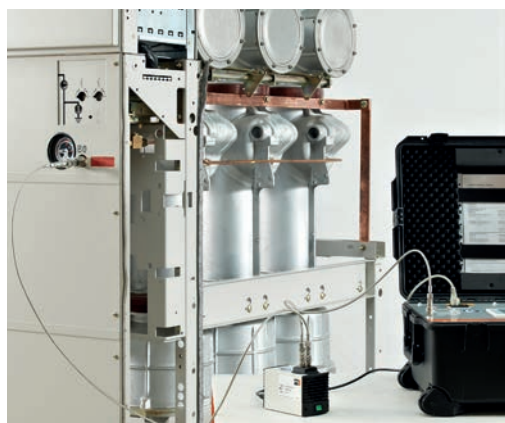
El compresor de membrana se conecta con el tubo de conexión correspondiente entre el interruptor de media tensión y el dispositivo de medición.
